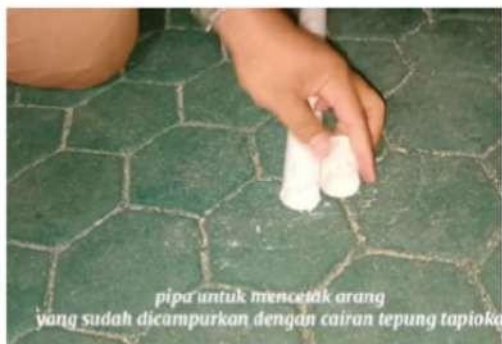
Gambar 7. Siapkan pipa, potong dan tambahkan cairan tepung tapioka ke dalam pipa
